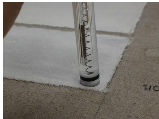
Fig. 62. Medição do valor de pH de uma superfície com eléctrodo de contacto. (A.P.)
