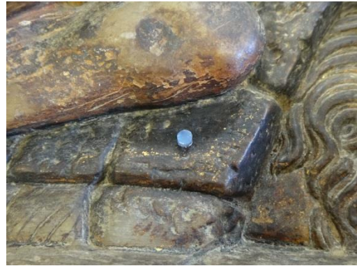
Fig. 64. Cilindro de agarosa sobre a superfície a medir. (A.P.)
