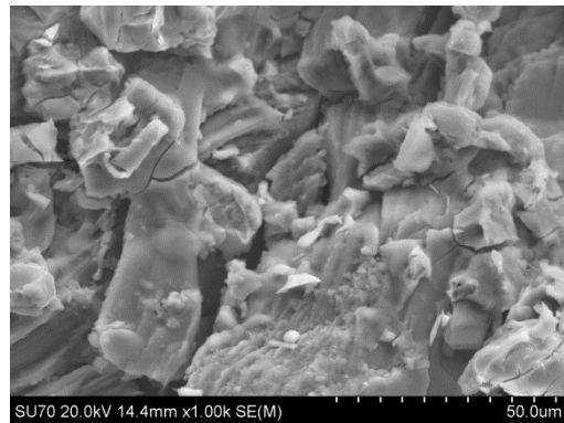
Fig. 100. Observação a partir de SEM da superfície de verdigris aglutinado em óleo de linhaça sobre alabastro envelhecida.
