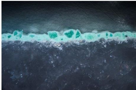
Fig. 89. Estratigrafia do provete de alabastro policromado com malaquita e cola, antes do envelhecimento, 200x. (Christopher Marques)
