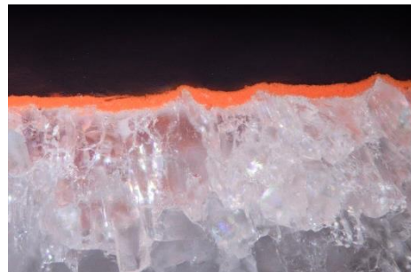
Fig. 92. Estratigrafia do provete de alabastro policromado com minium e cola, depois do envelhecimento, 200x. (Christopher Marques)
