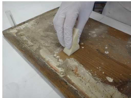
Fig. 112. Limpeza com esponja de maquiagem. (A.P.)
