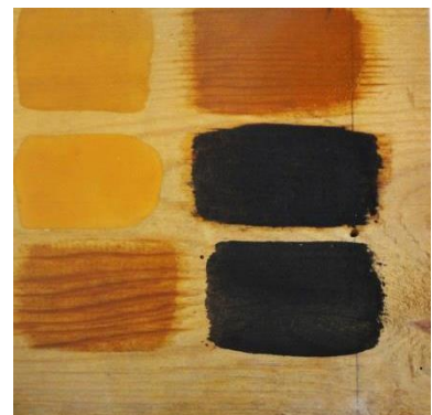
Fig. 56. Testes de proporções entre aglutinante e pigmento em provete de alabastro. (A.P.)
