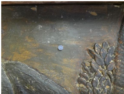
Fig. 128. Cilindro de gel rígido de agarosa como veículo para medir valores de pH e condutividade de superfícies. (A.P.)
