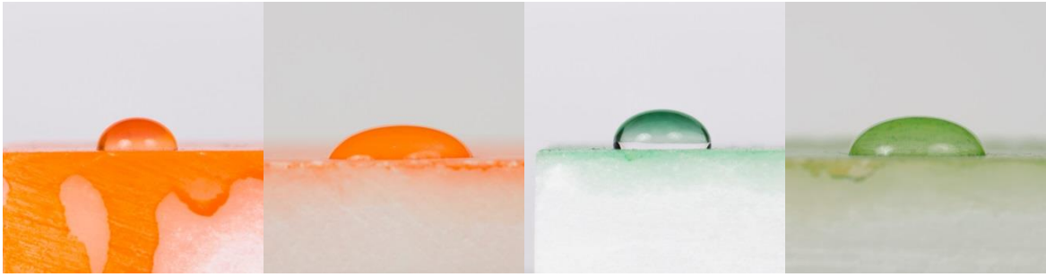
Fig. 83. Ângulo de contacto entre gota e superfície de minium aglutinado em óleo sobre alabastro antes de envelhecimento. (Christopher Marques)
