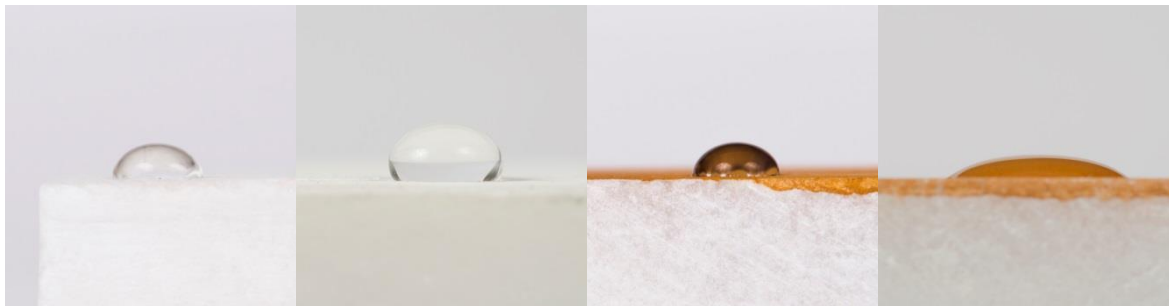
Fig. 79. Ângulo de contacto entre gota e superfície de branco de chumbo aglutinado em cola sobre alabastro antes de envelhecimento. (Christopher Marques)
