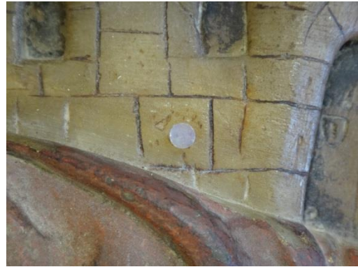
Fig. 73. Cilindro de agarosa sobre a superfície a medir. (A.P.)
