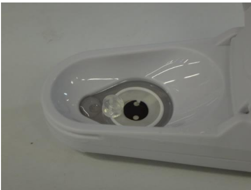
Fig. 65. Cilindro de agarosa no medidor. (A.P.)
