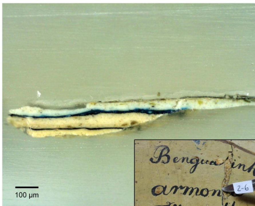
Fig. 8. Corte estratigráfico da camada cromática de amostra recolhida na zona branca da cartela com quadra inserida na cartela superior da 2. a folha do biombo. Microscopia óptica, ampliação de 40 \times .
