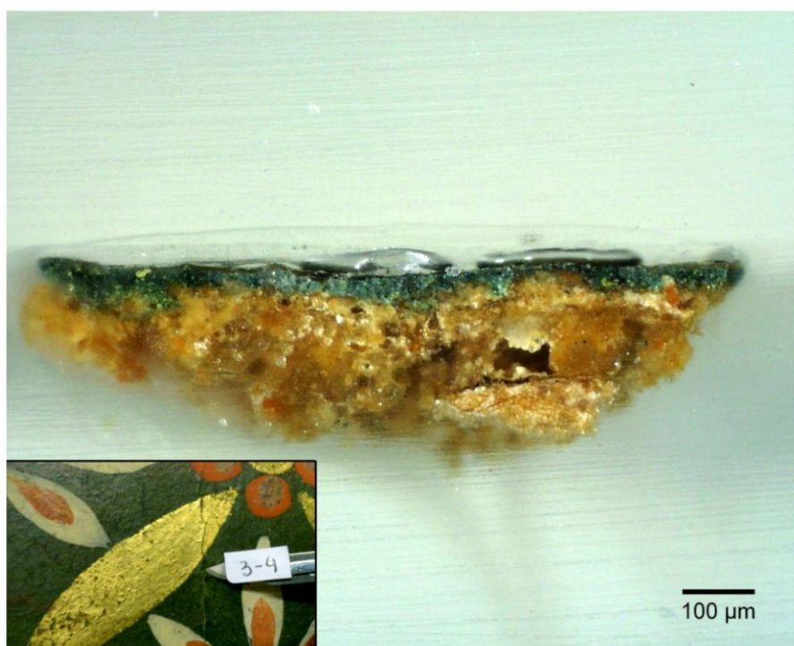
Fig. 5. Corte estratigráfico da amostra recolhida numa zona de cor verde da barra superior com flores da 3.ª folha do biombo. Microscopia óptica, ampliação de 40×.
