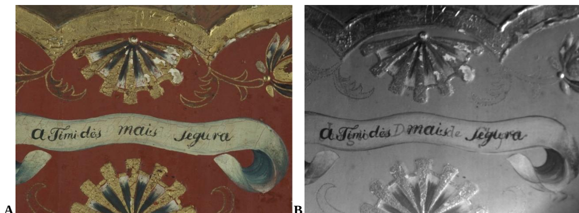
Figura 19 A - pormenor da filactera inferior da folha 3 do biombo, com frase que a olho nu se percebe que se sobrepõe a outra frase; B - imagem no espectro visível (Gonçalo Figueiredo, IPT); à direita imagem de multiespectral no IV a 1050 nm.
