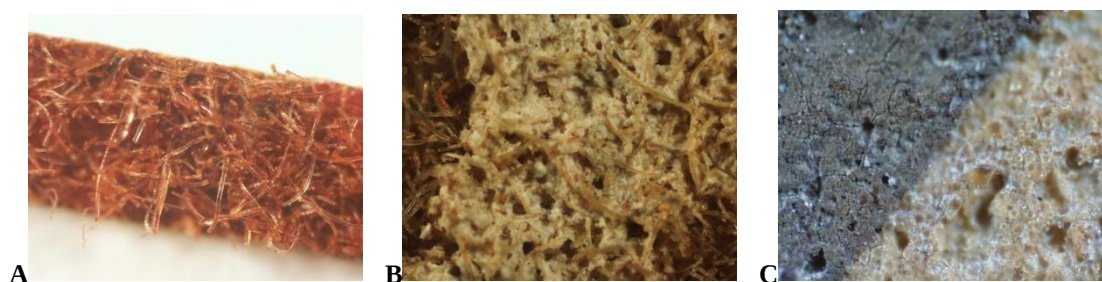
Figura 26 A - pormenor da superfície do papel A1 (ampliação 40x); B - pormenor da superfície do papel A2 (ampliação 100x); C - pormenor da superfície do papel A3 (ampliação 100x). Fotografias obtidas no microscópio óptico
