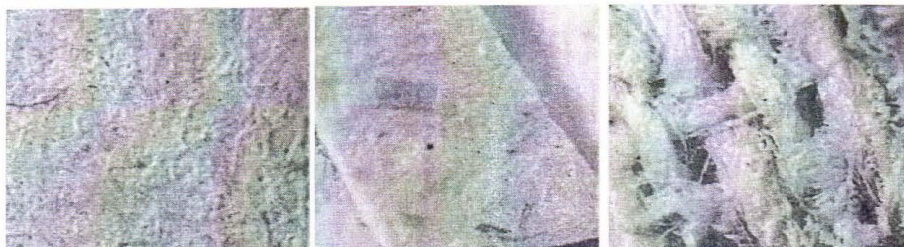
Microfotografias de dois papéis e duma tela, ampliação 40x. © Cristina Morais.
