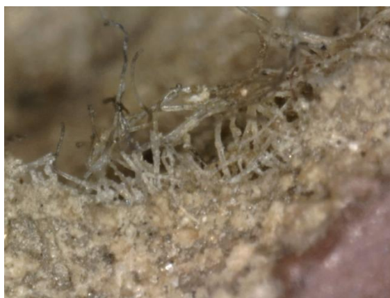
Figura 9 Pormenor de fotografia obtida com Dinolite, numa zona de lacuna, em que se observam as fibras soltas, ampliação 230 x
