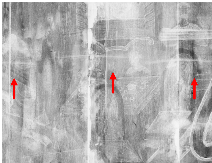
Figura 7 Radiografia da cartela inferior da folha 5 onde se observam as cavilhas. (Radiografia de Vítor Gaspar - Laboratório de Física e Química e Raio- X do IPT e fotografia de Gonçalo Figueiredo - Laboratório de Fotografia do IPT)
