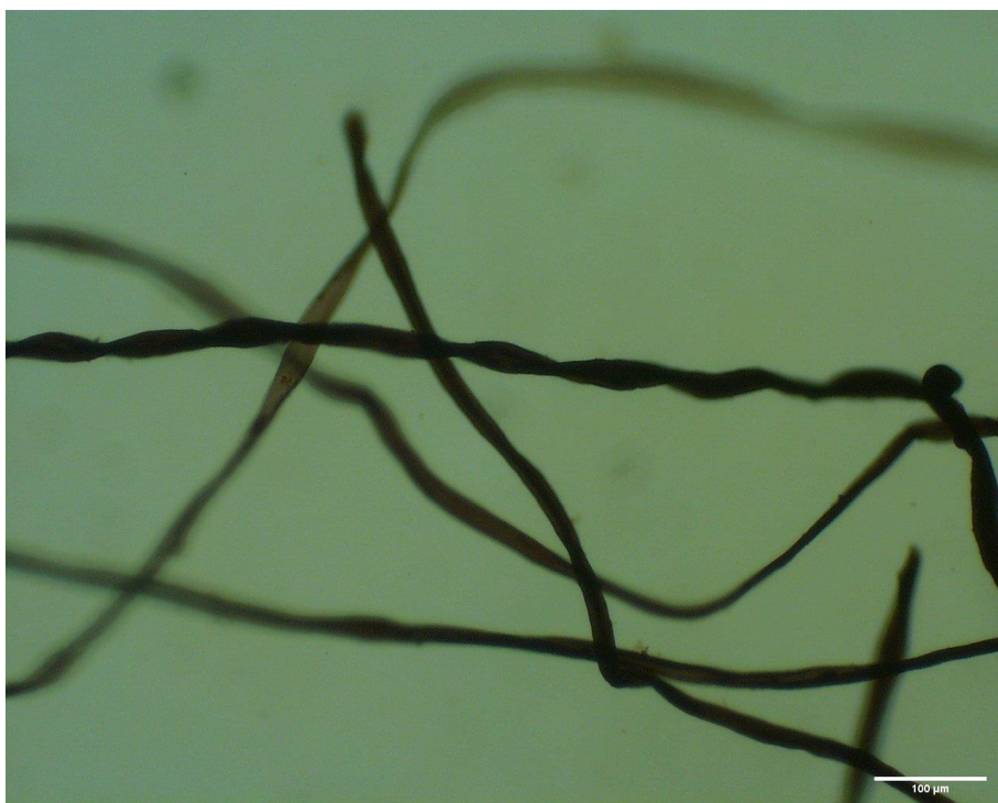
Figura 76- Observação ao microscópio de fibra de tela de reentelagem 100x
