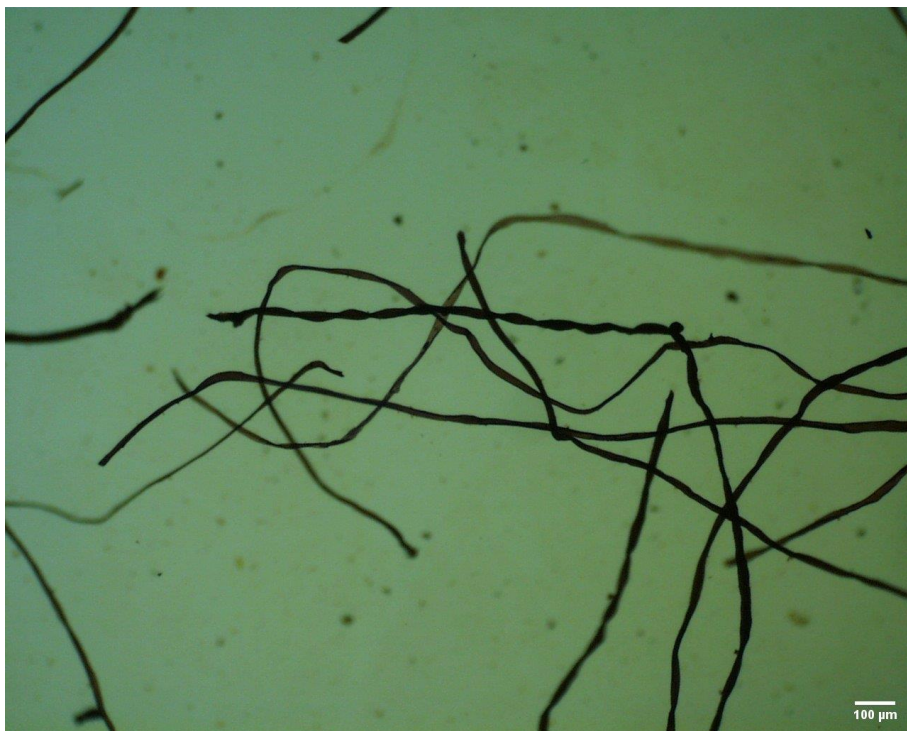
Figura 77- Observação ao microscópio de fibra de tela de reentelagem 40x
