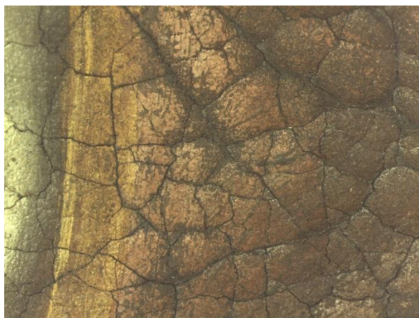
Figura 62- Pormenor da pintura, sob lupa binocular, a 16x
