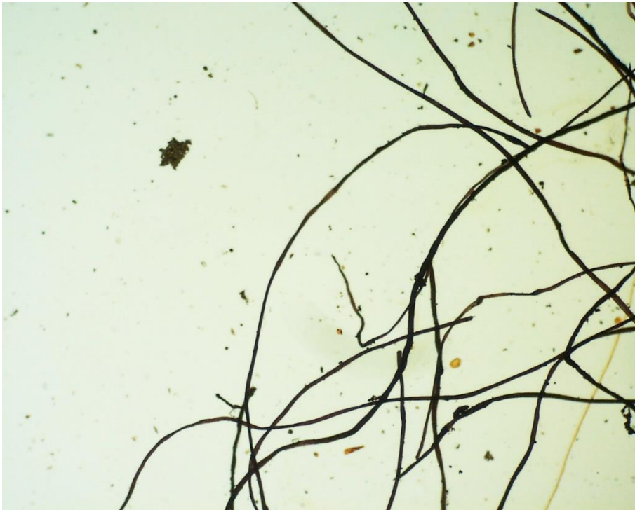
Figura 80-Observação ao microscópio de fibra de linha de costura 40x
