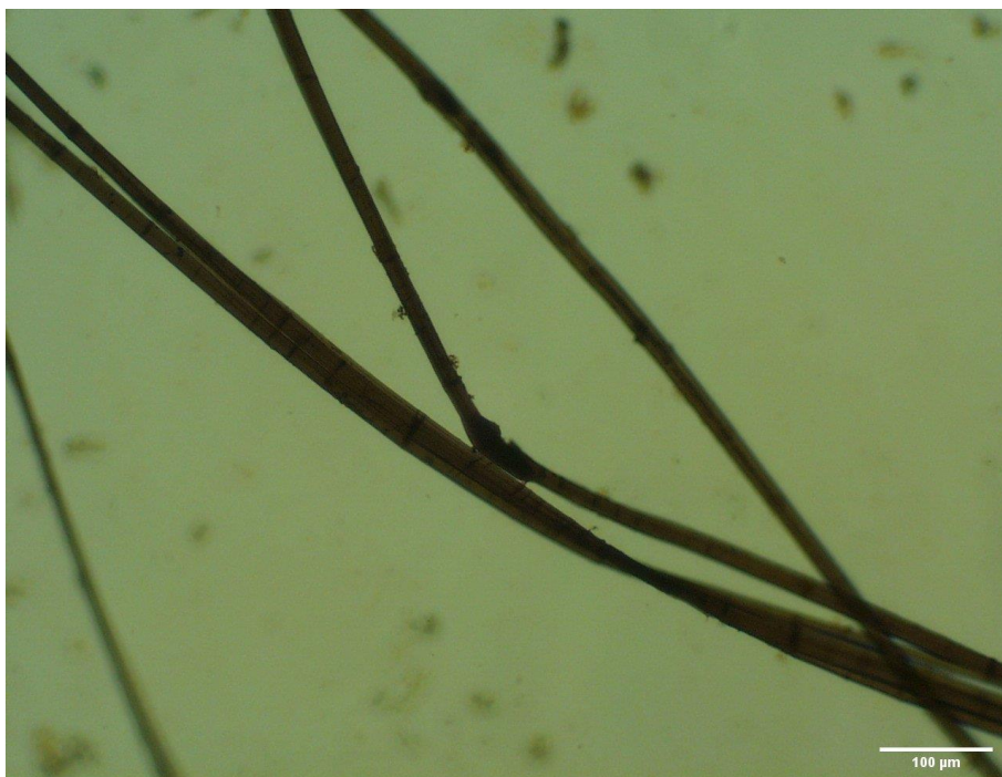
Figura 75- Observação ao microscópio de fibra de tela original 100x
