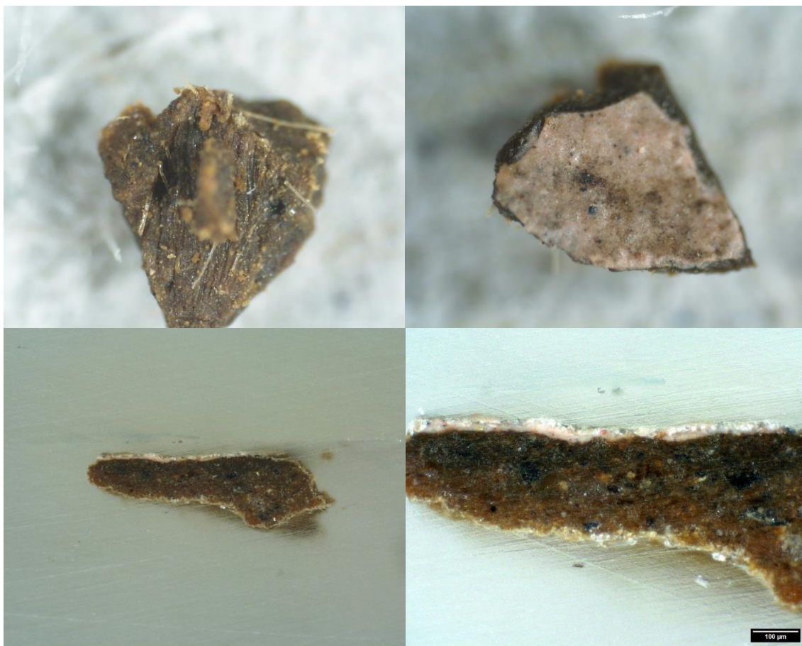
Figura 87- Observação microscópica de amostra estratigráfica 3, visão inferior e superior, 40x e 100x, respetivamente
