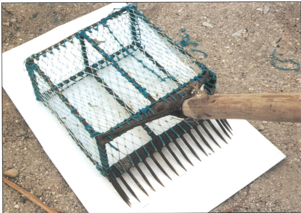
Fotografia 10 - Berbigoeira, draga de mão com cabo (rede de poliamida).
