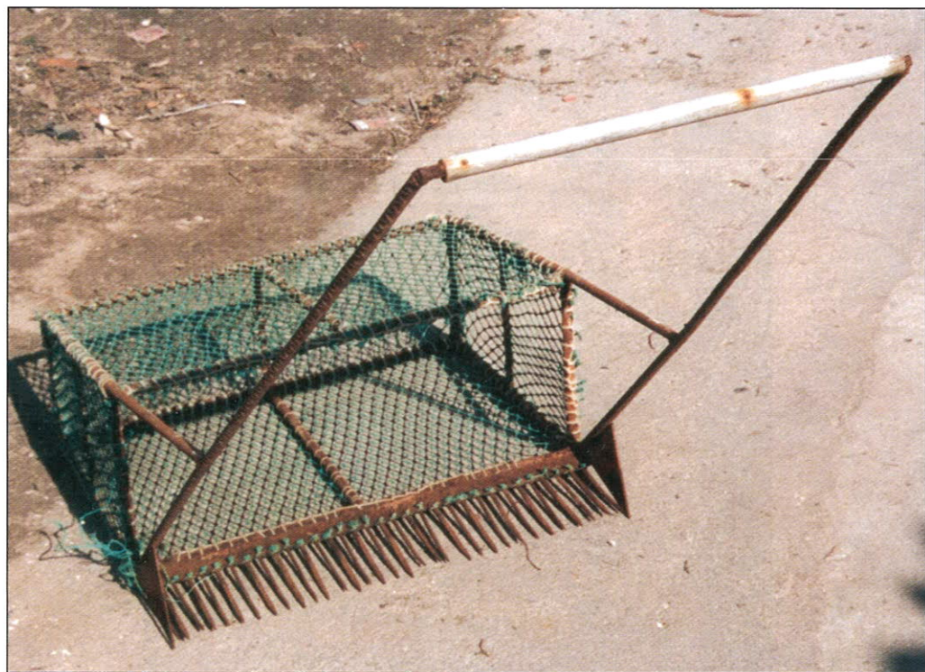
Fotografia 12 - Berbigoeira, draga de mão com barra de tracção.
