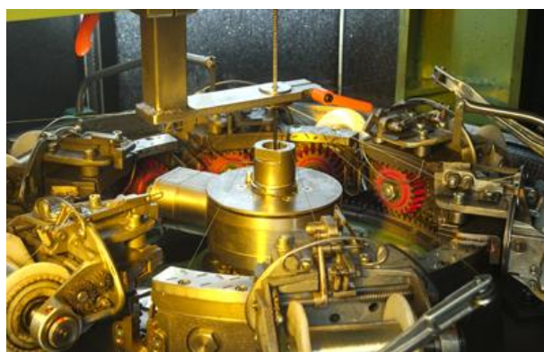
Figura 16 - Extrusora de blindagem [12].
