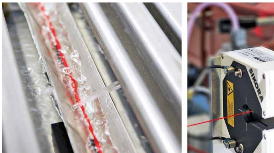
Figura 20 - Arrefecimento do revestimento e respetivo controlo [18].
