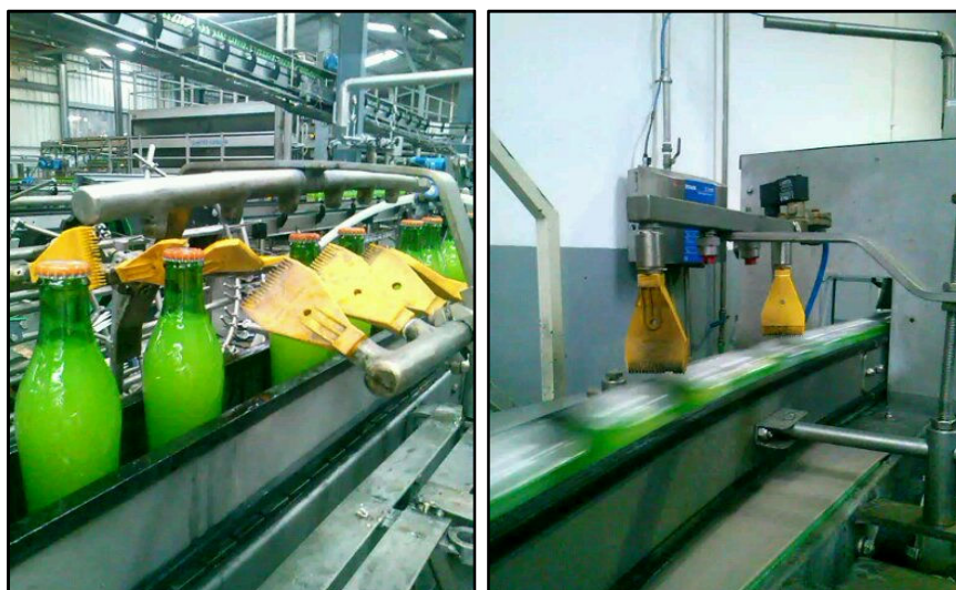
Figura 8.12 - Secagem de garrafas de vidro e latas em linha
