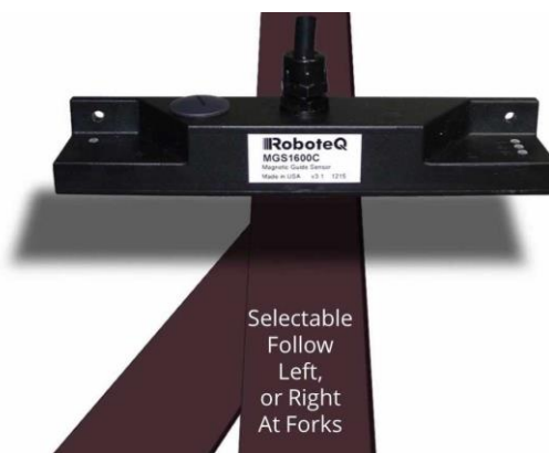
Figura 24 - Imagem do sensor magnético MGS1600 sobre uma fita magnética.
