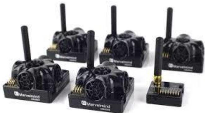
Figura 27 - Kit de beacons para o cálculo da posição global do robô móvel.
