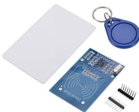
Figura 10 - Modulo completo de Leitura/ Escrita e respectivas tags de armazenamento de informação passiva.
