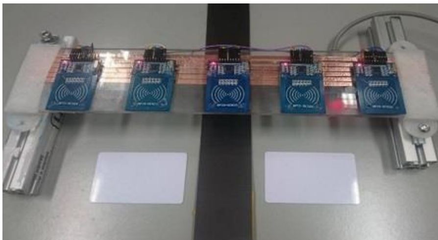
Figura 25 - Protótipo de uma Régua de Leitores de tags RFID usado na plataforma robótica.
