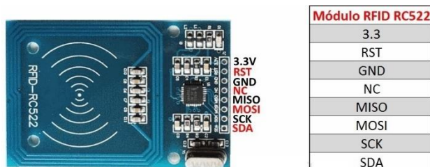
Figura 9 - Modulo de Leitura/Escrita RFID RC522 e descrição dos pinos de comunicação.
