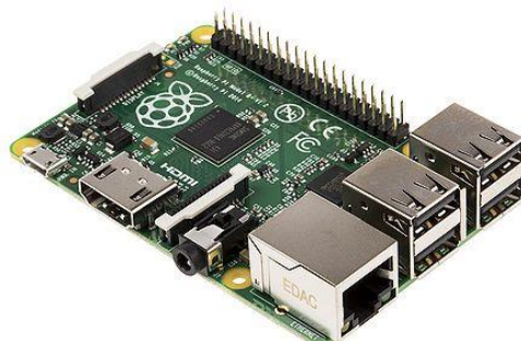
Figura 19 - Raspberry Pi 2, SOC usado no robô móvel para controlar os movimentos da mesma.
