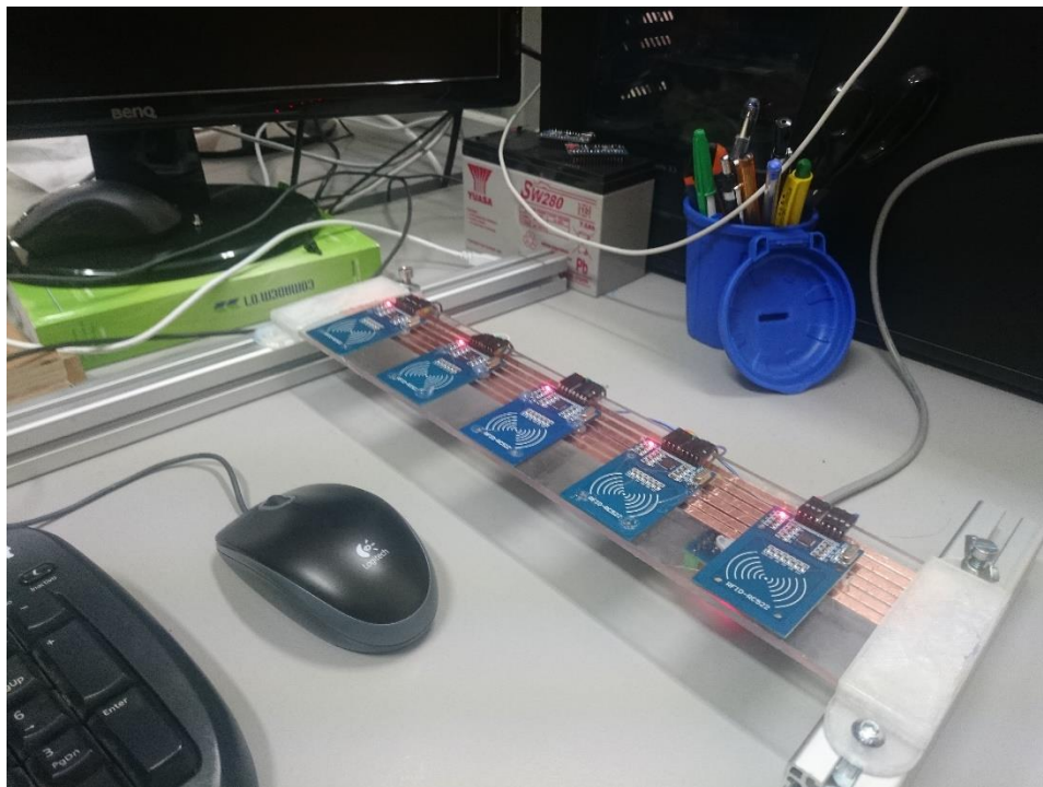
Figura 38 - Protótipo da régua de sensores RFID.
