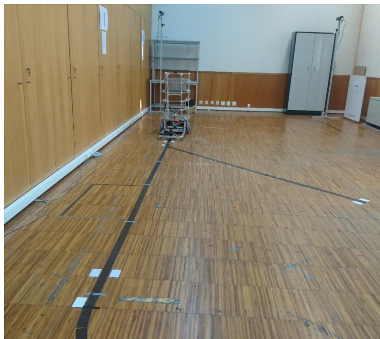
Figura 60 - Disposição geométrica do conjunto de tags em paralelo com a fita magnética e partes do trajeto sem fita.
