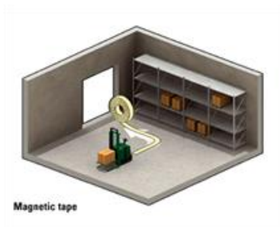
Figura 2 - Colocação de faixa magnética sob a superfície
