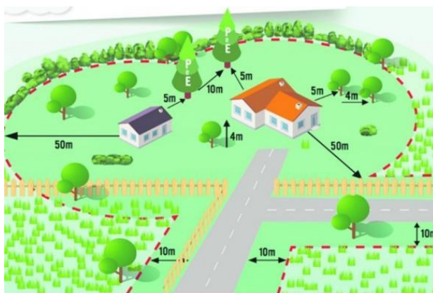
Figura 15 – Limpeza ao redor das habitações
