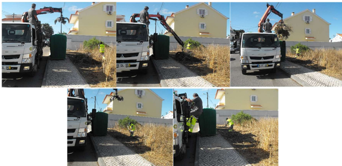
Figura 11 - Tarefas realizadas pelos assistentes operacionais no decorrer da atividade de recolha de envoltórios de contentores (resíduos verdes e “monos” domésticos) com veículo com grua
