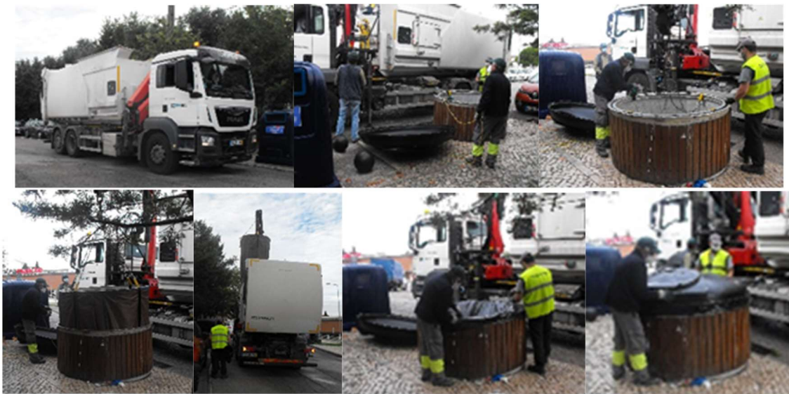
Figura 9 - Tarefas realizadas pelos assistentes operacionais no decorrer da atividade de recolha de RUI em contentores semienterrados (tipo Molok)
