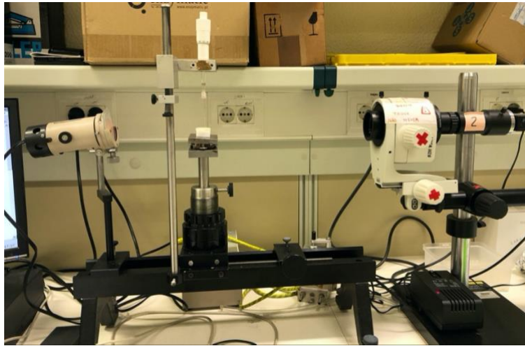
Figura 18 – Goniómetro - Da direita para a esquerda observa-se a fonte de luz, a microseringa sobre o espécime, o sistema ótico e câmara de vídeo (Elaborada pelo autor)
