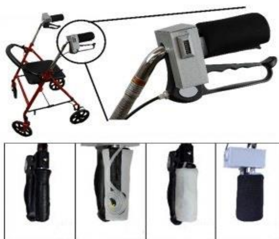
Figura 7 – Punho instrumentado com sensores de pressão e alarme vibratório ( Bhutada et al. , 2017).
