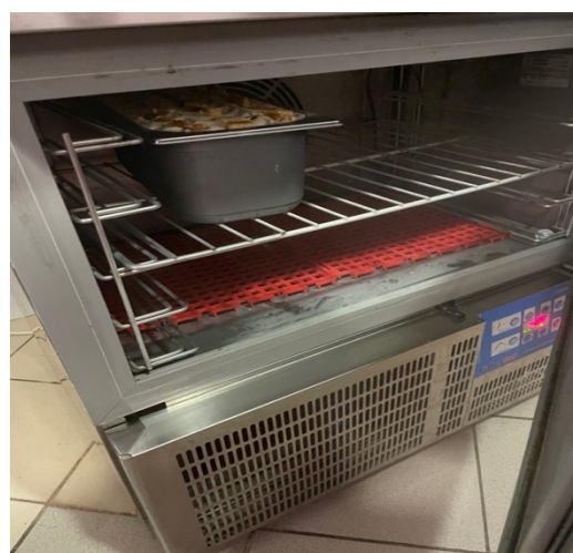
Figura 18 - Cuvete no abatedor de temperatura (autoria própria)
