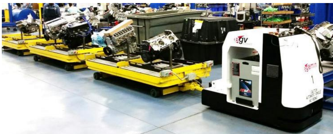
Figura 37 - Exemplo de um veículo de orientação automático – AGV (Fedorko, Molnar, Honus, Neradilova, & Kampf, 2018)
