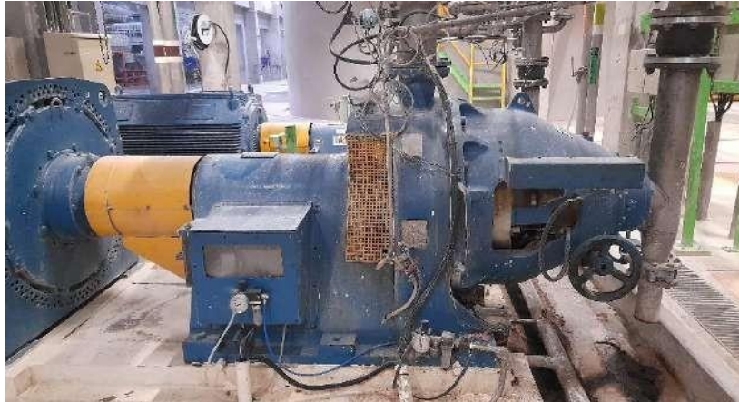
Figura 62 - Refinador RTC_2000 Grande - RF603
