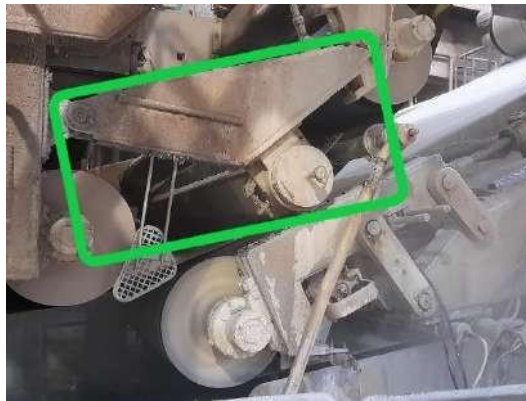
Figura 16 - Caixa de Vácuo "Pick Up" da MP6
