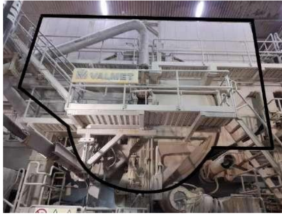
Figura 4 - Secção da Secagem
