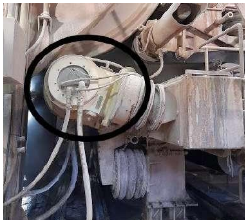
Figura 17 - Prensa Aspirante ou Rolo nº12 da MP6
