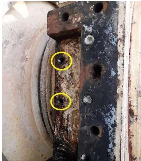
Figura 87 - MELHORIA-Furos para colocação da tranca (MP5)
