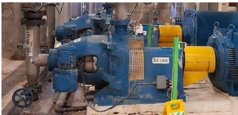
Figura 65 - Refinador RTC_1000 - RF602
