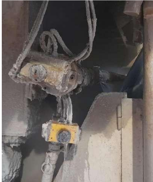
Figura 64 - Regadeira de alta pressão da teia exterior - R612
