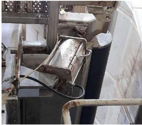
Figura 9 - Tensor da teia exterior
