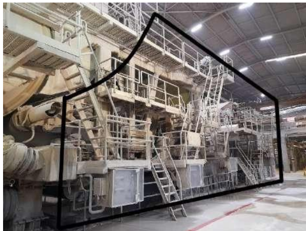
Figura 3 - Secção da Formação
