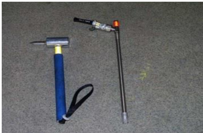
Figura 24 - Martelo perfurante e agulheta de nevoeiro direcionada para combate incêndios (Falkman, Firefighting in large FRP composite cruise ships, 2012, p. 28)
