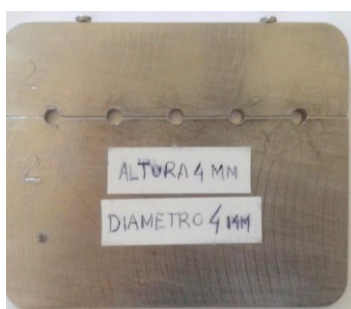
Figura nº 16- Molde metálico com 5 poços cilíndricos de 4 mm de diâmetro por 4 mm de profundidade, usado na confecção dos espécimes de resina.
