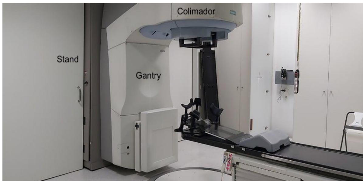
Figura 23: Rótulo das diferentes estruturas do Acelerador Linear do IPOCFG
