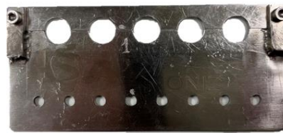
Figura 8. Molde em aço inoxidável, utilizado na preparação dos discos.
