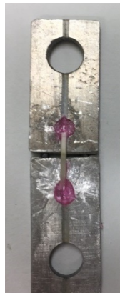
Figura 23 - Palito colocado no jig com cola de cianoacrilato (Zapit, Dental Ventures of America, Corona, CA, USA).
