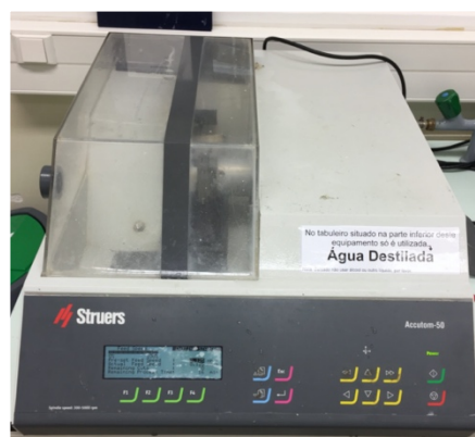
Figura 4 - Micrótomo de tecidos duros (Accutom-50, Struers, Denmark).
