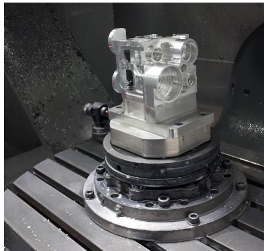
Figura 3.21: Finalização do segundo aperto.
