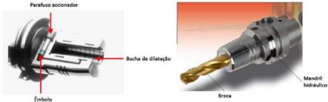
Figura 2.10: Sistema de fixação hidráulica (Chocalheiro, 2012).
