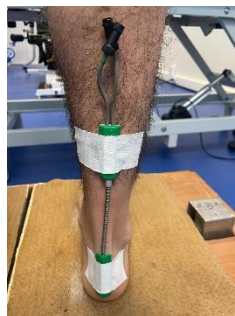
Figura 3 – Posicionamento do eletrogoniómetro
