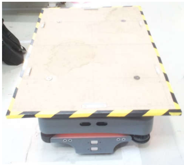
Figura 35 - AMR preparado para ensaios.
