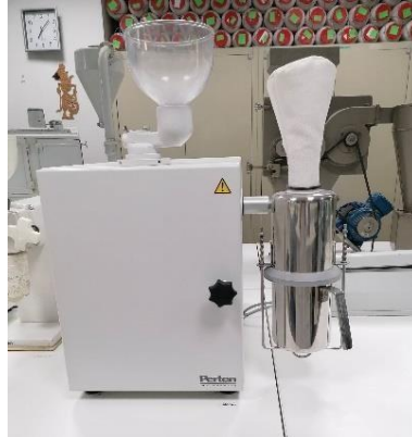
Figura 18 Equipamento moedor de grãos de arroz
