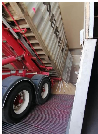
Figura 9 Descarga de arroz no tegão
