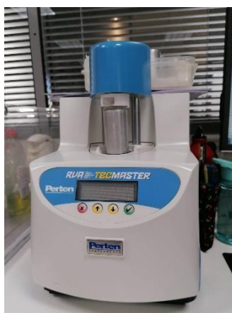
Figura 21 Equipamento de RVA
