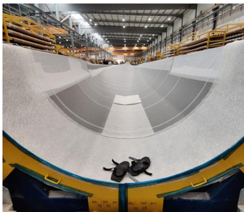
Figura 17 - Disposição das várias camadas de fibra no molde
