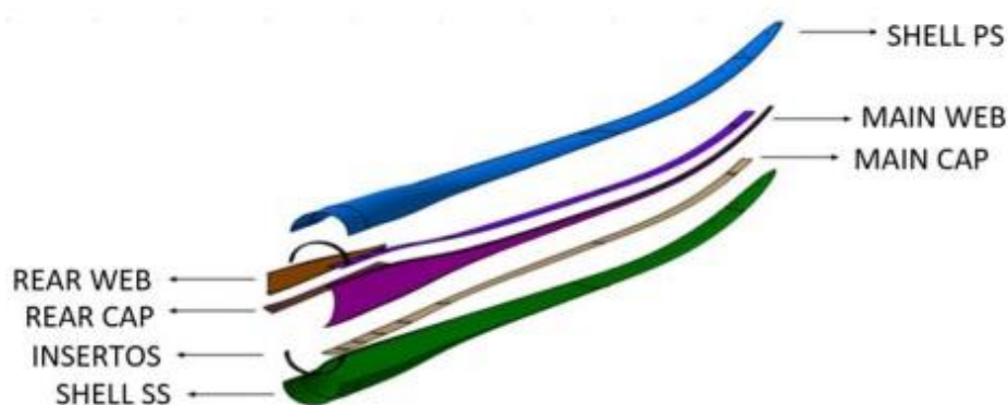
Figura 15 - Pá representada em vista explodida (Fonte: Siemens Gamesa)
