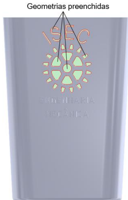
Figura 25 - Resultado da criação das superfícies para tapar os furos e as geometrias vazadas do porta-canetas.
