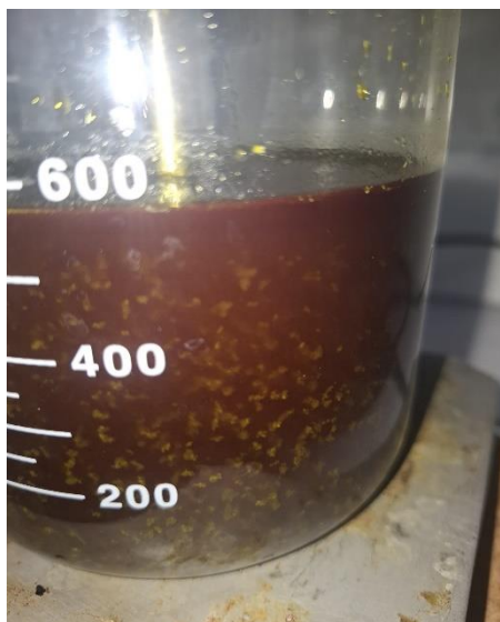
Figura 18 - Teste 3, adição de ácido fosfórico a 60°C e soda cáustica a 70°C.
