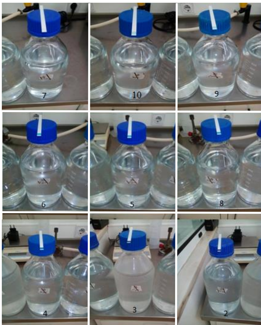
Figura 2.15 - Exemplos de tiras colorimétricas após serem mergulhadas na amostra para várias concentrações com desinfetante Divosan Activ Vt5 . 7 – 0,5 ppm; 10 – 0,0630 ppm; 9 – 0,625 ppm; 6 – 2 ppm; 5 – 5 ppm; 8 – 6,65 ppm; 4 – 10 ppm; 3 – 2,5 ppm; 2 – 62,5 ppm.
