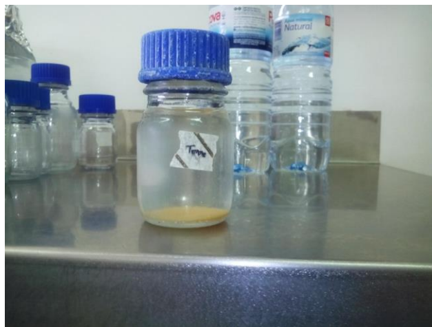
Figura 2.33 - Água no ponto de recolha da torre de refrigeração após ter ido esterilizar à autoclave.
