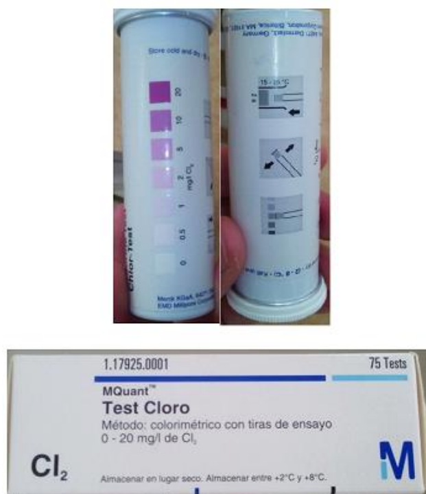
Figura 2.1 - Chlorine Test, com indicação das cores respetivas a cada concentração de \text{Cl}_2 (em mg/L) e o procedimento para o uso das tiras.
