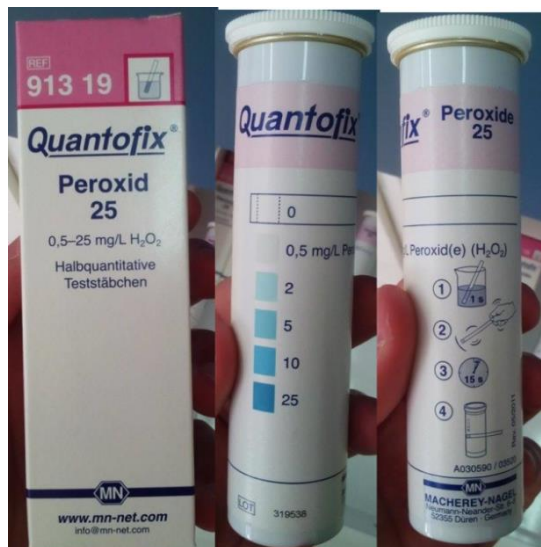
Figura 2.2 - Peroxide Test, com indicação das cores respetivas a cada concentração de H 2 O 2 (em mg/L) e o procedimento para o uso das tiras.
