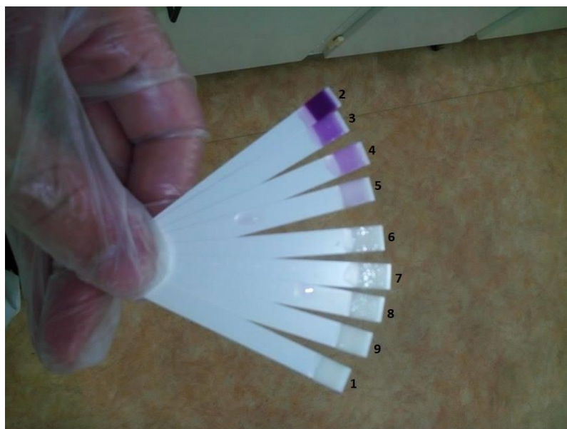
Figura 2.3 – Exemplos de tiras colorimétricas após serem mergulhadas na amostra para várias concentrações com desinfetante Divosan Hypochlorite Vt3 . 2 – 65 ppm; 3 – 10 ppm; 4 – 6,5 ppm; 5 – 3 ppm; 6 – 1 ppm; 7 – 0,65 ppm; 8 – 0,5 ppm; 9 – 0,1 ppm; 1 – 0 ppm.
