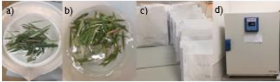
Figura 17 - a) Solução de água corrente e detergente; b) Solução de água destilada; c) Envelopes com respectivas amostras; d) Estufa Thermo Scientific: Heratherm OMSI 80
