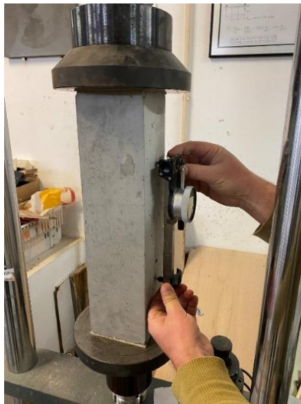
Figura 33: Ensaio para determinação do módulo de elasticidade do betão.
