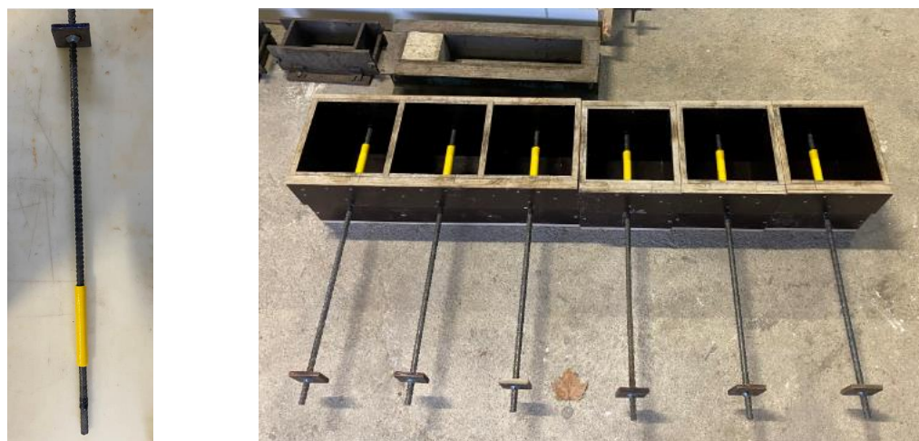
Figura 42: Preparação e posicionamento dos varões nos moldes dos provetes para ensaio pull-out.
