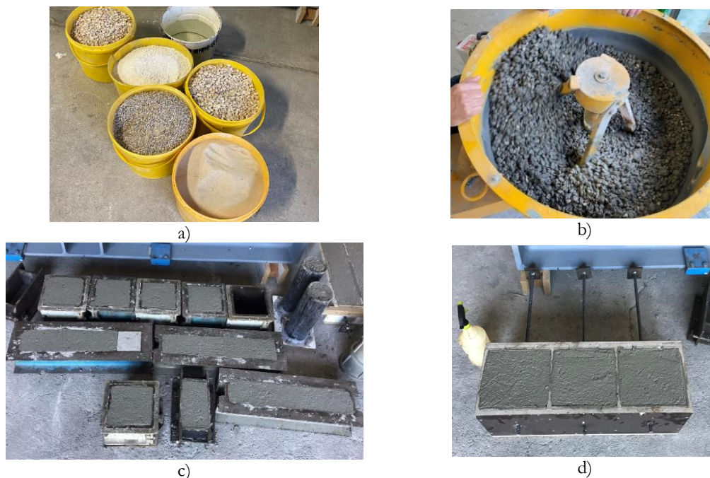
Figura 30: Betonagem: a) Pesagem dos materiais; b) Misturadora trabalhando; c) Enchimento dos moldes para ensaios mecânicos e de durabilidade; d) Enchimento de provetes para ensaios de pull-out.
