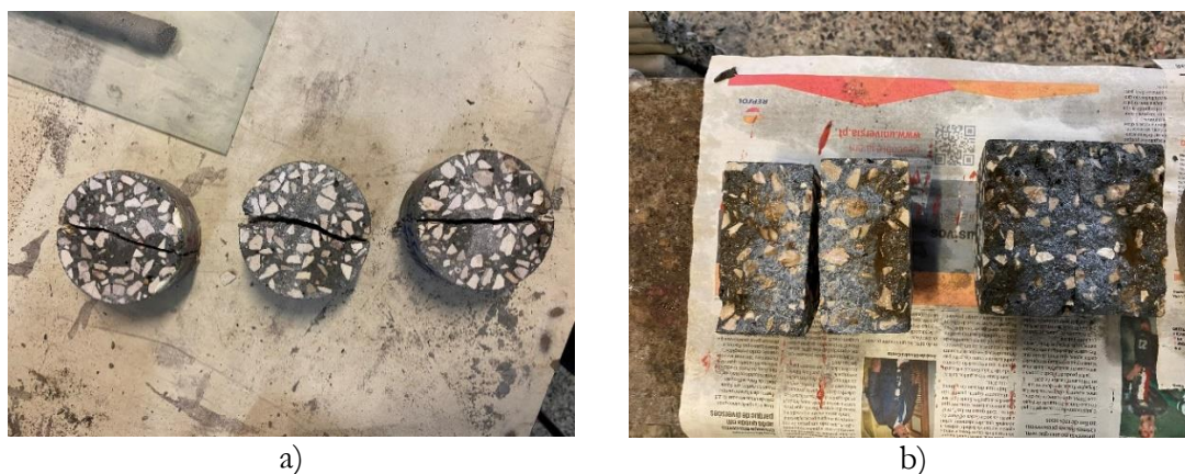
Figura 38: a) Provetes em betão partidos ao meio; b) Provetes com as superfícies pulverizadas com nitrato de prata.
