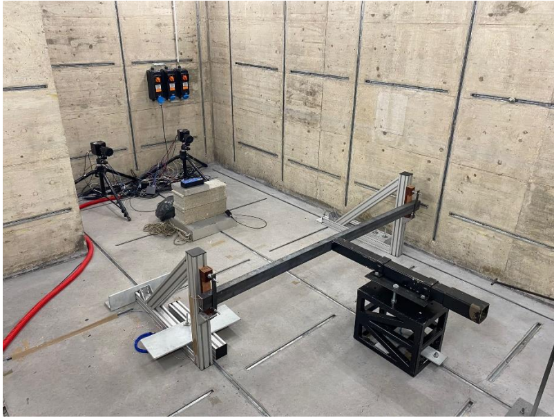
Figura 37 - Posicionamento das câmaras em relação à viga.
