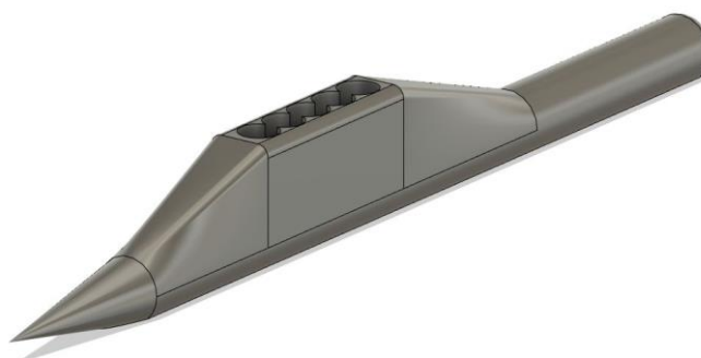
Figura 22 - Suporte dos sensores de pressão, impresso em 3D. Espaçamento entre orifícios é de 13 milímetros (de centro a centro).
