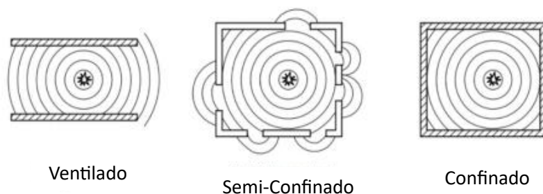
Figura 8 - Explosões Confinadas (Adaptado de [14])
