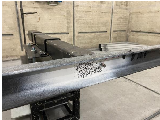
Figura 38 - Padrão de reconhecimento para o software DIC e o acelerómetro colocado na viga.
