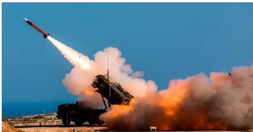
Figura n.º 9 - míssil PAC-2 a ser disparado de um LCHR do sistema PATRIOT
