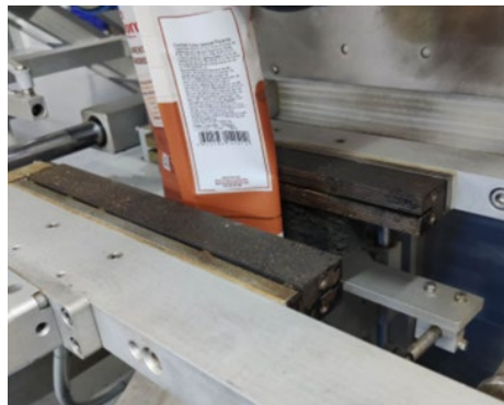
Figura 4.21 – Soldadura Horizontal e Corte
