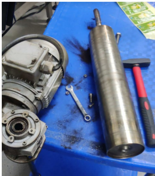
Figura 4.43 – Retirada do veio do motor
