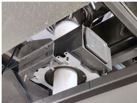
Figura 4.9 – Detetor de Metais da Linha 4
