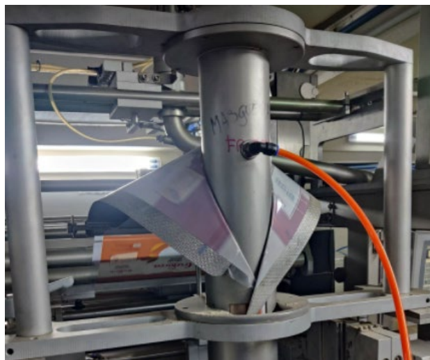
Figura 4.17 – Colarinho do Tubo formador
