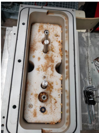
Figura 4.35 – Molde Inferior da Termosseladora antes da ação de Limpeza
