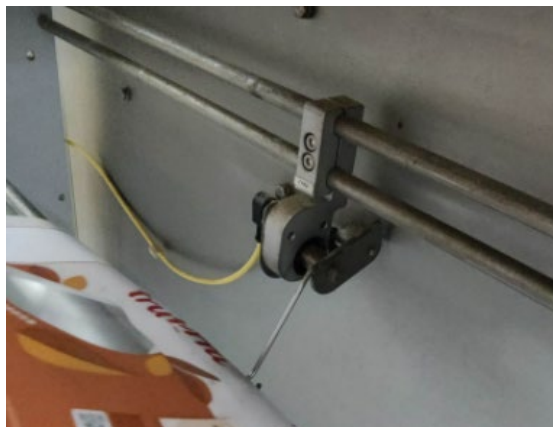
Figura 4.12 – Sensor de Deteção de Fim de Filme
