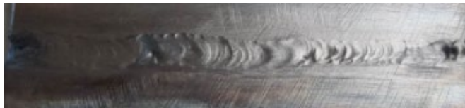
Figura 4.54 – Soldadura TIG após limpeza
