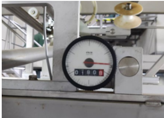
Figura 4.16 – Componente que Movimenta Manualmente o Quadro da Máquina
