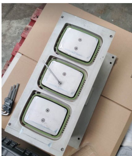
Figura 4.36 – Molde Inferior da Termosseladora após a Limpeza
