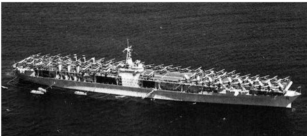
Figura 7 – O USS Ranger, o primeiro dos porta-aviões norte Americanos a ser construído desde o início como tal, demonstra a ênfase colocada desde o início pela Marinha dos Estados Unidos em grandes grupos aéreos e a utilização de Hangares (semi) abertos para facilitar as operações aéreas ao permitirem aquecer os motores dentro do hangar
