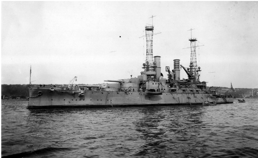
Figura 4 – O USS Michigan da classe South Carolina os primeiros couraçados com a clássica disposição sobreposta (o termo inglês “superfiring” não tem tradução direta para português) 4x2 do armamento principal
