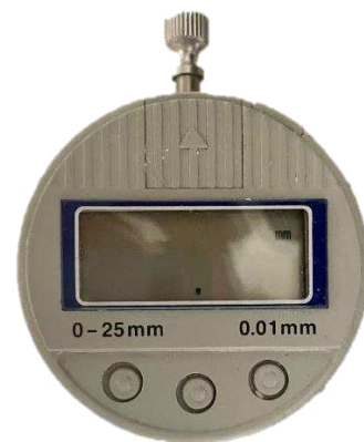
Figura 4. Paquímetro digital do calibrador de instrumentos rotatórios
