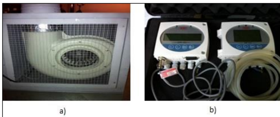
Figura 3.2 - a) Ventilador para ensaios e b) Unidade portátil para teste de estanqueidade das condutas.
