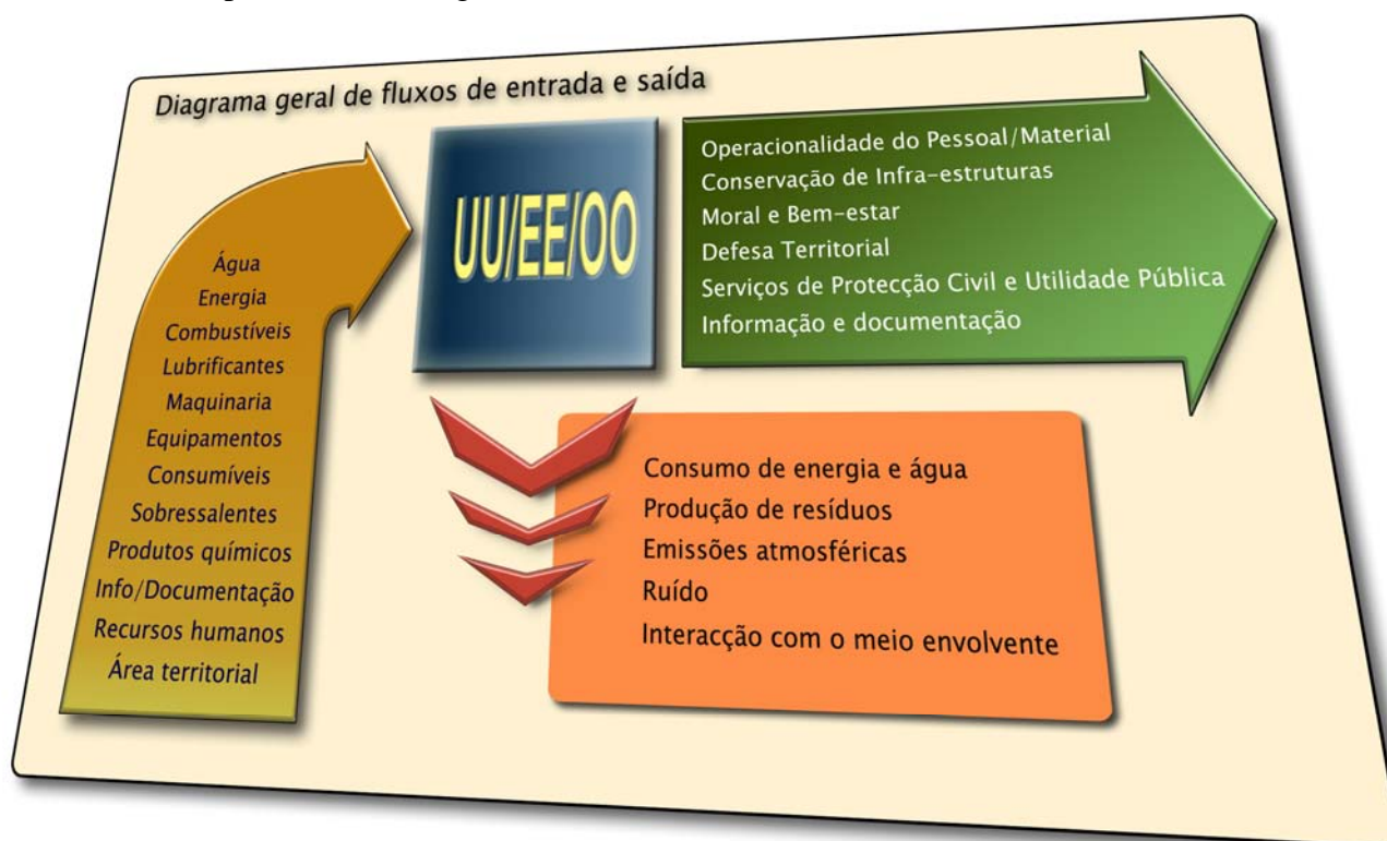
Figura 2 – Diagrama geral de fluxos de entrada e saída de uma UU/EE/OO genérica (Adaptado de Mascarenhas e Neves, 2004, p. 19)
