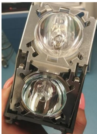
Figura 37: Sistema de comutação das lâmpadas do microscópio.
