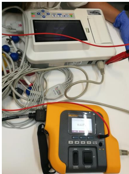
Figura 40: Teste de Segurança Elétrica a um eletrocardiógrafo.
