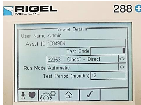
Figura 17: Display do equipamento de Teste de Segurança Elétrica aquando de um teste a um monitor multiparamétrico.
