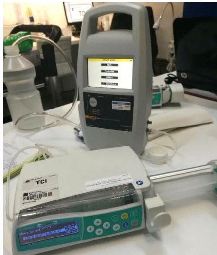
Figura 30: Ensaio de parâmetros (fluxos e pressão de oclusão) de uma bomba de infusão com seringa.
