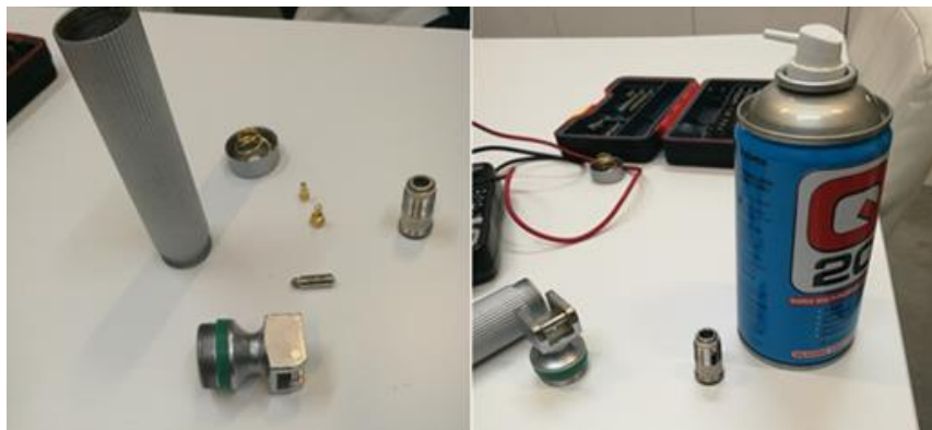
Figura 63: Laringoscópio desmontado para posterior colocação de produto para sistemas elétricos.
