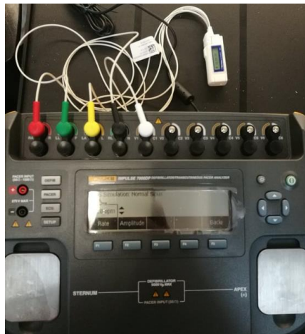
Figura 43: Ensaio de ECG de um Holter .
