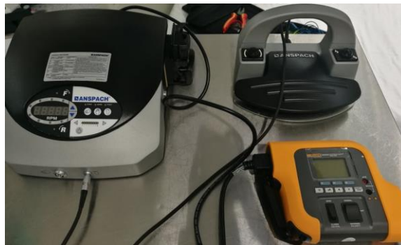
Figura 33: Teste de Segurança Elétrica a uma bomba de irrigação.
