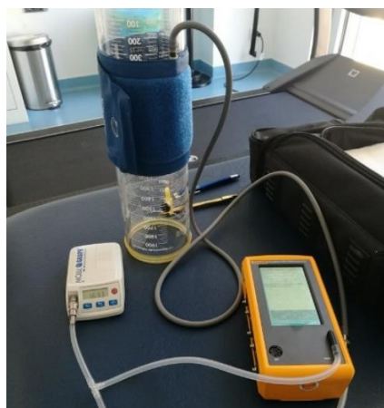
Figura 45: Ensaio de parâmetros de uma MAPA.
