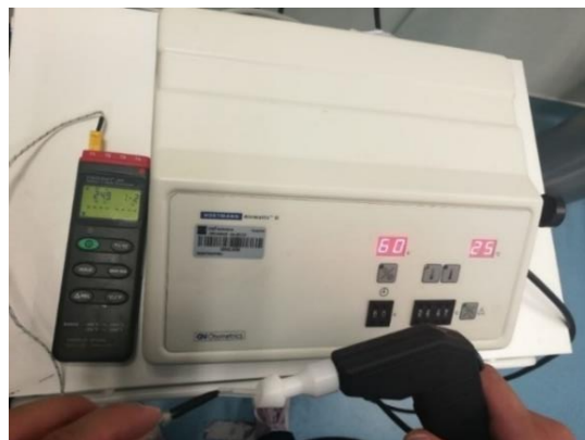
Figura 52: Ensaio de temperatura de um irrigador calórico.
