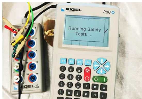
Figura 18: Ligação da tomada de alimentação e dos eléctrodos ao equipamento de teste e acessório, respetivamente.
