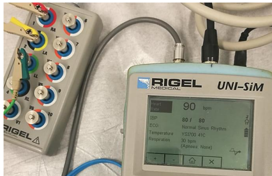
Figura 19: Simulação de um sinal ECG com frequência cardíaca de 90 batimentos por minuto.
