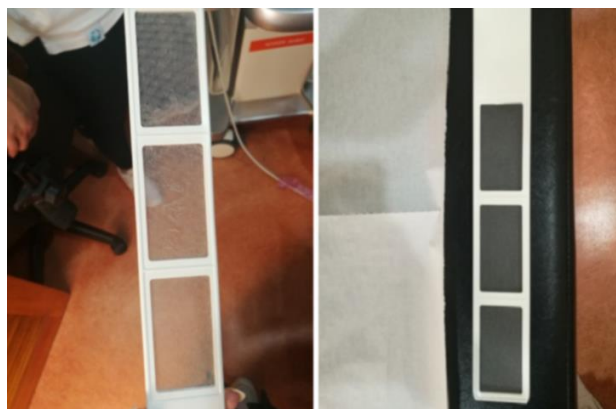
Figura 67: Antes e depois da limpeza do filtro.
