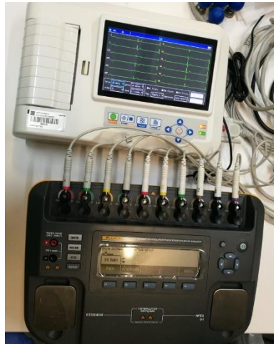
Figura 41: Ensaio de parâmetros de um eletrocardiógrafo utilizando o equipamento de teste adequado.
