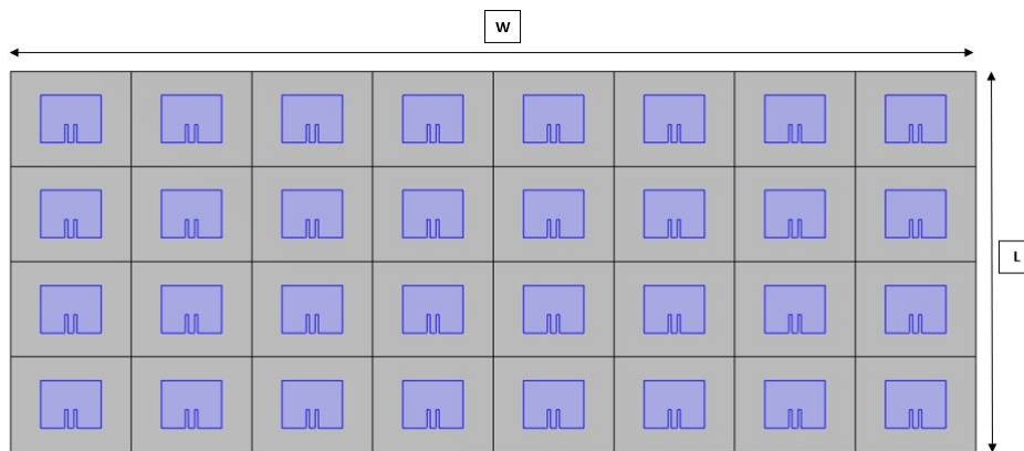
Figura 3.14: Representação frontal do agregado com 32 patch no COMSOL Multiphysics ( W = 16.1808\mu\text{m} e L = 6.3728\mu\text{m} ).
