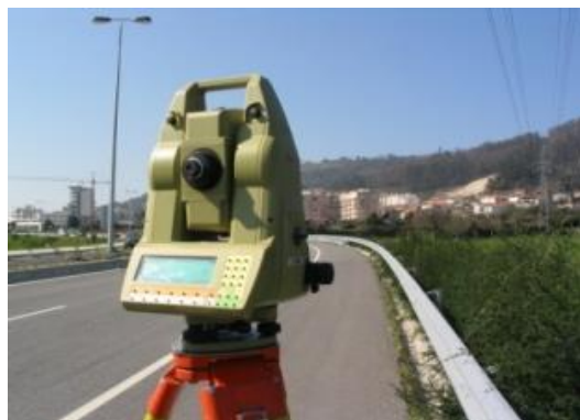
Figura 35 – Estação Total Levantamento Topográfico [29]
