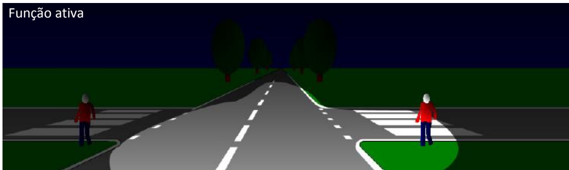
Figura 64 - Iluminação estática de curva – função ativa.
