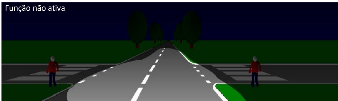
Figura 63 - Iluminação estática de curva – função não ativa.
