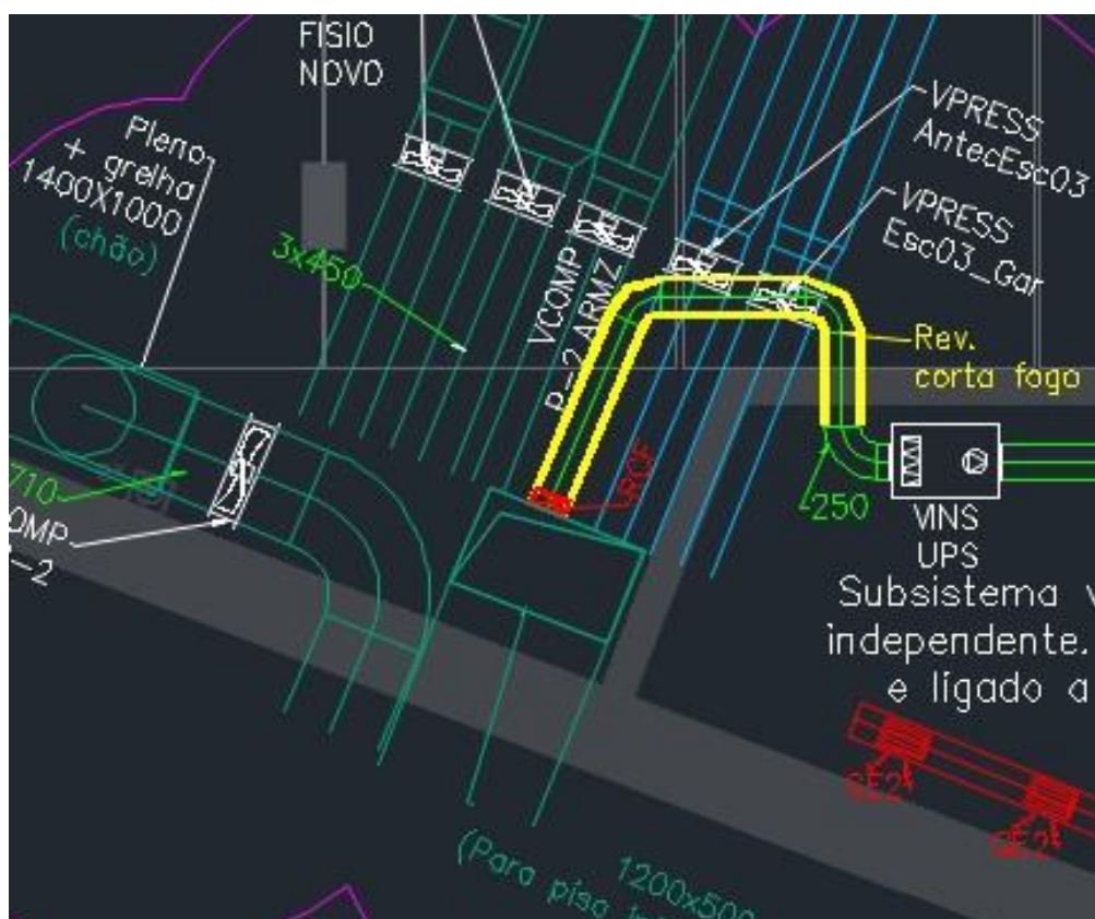
Figura 3.21 – Disposição inicial dos ventiladores sobrepostos com nova alteração da arquitetura.
