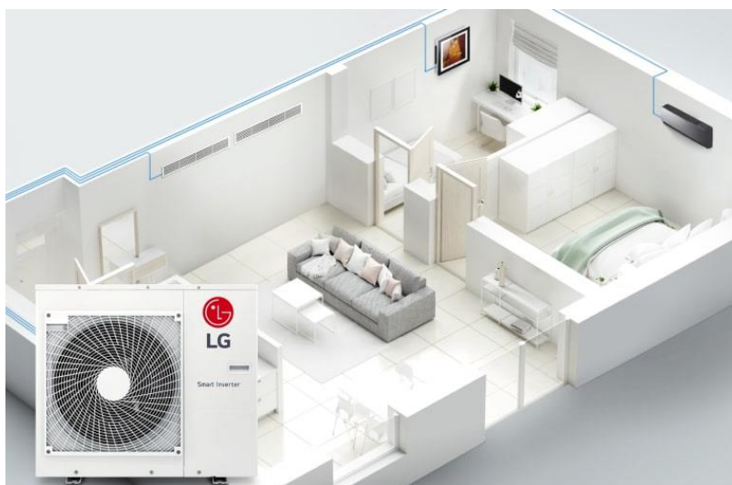
Figura 2.8 – Esquema de um Sistema Multi-Split LG.
