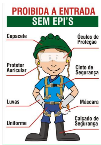
Figura 3.19 – Aviso de utilização de equipamentos de proteção individuais (EPI).
