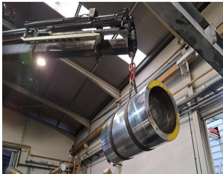
Figura 6.6: Retirada do cilindro para retificação
