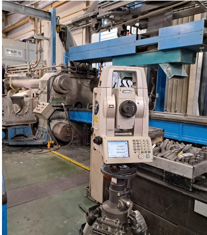
Figura 6.5: Verificação do alinhamento da prensa através de teodolito
