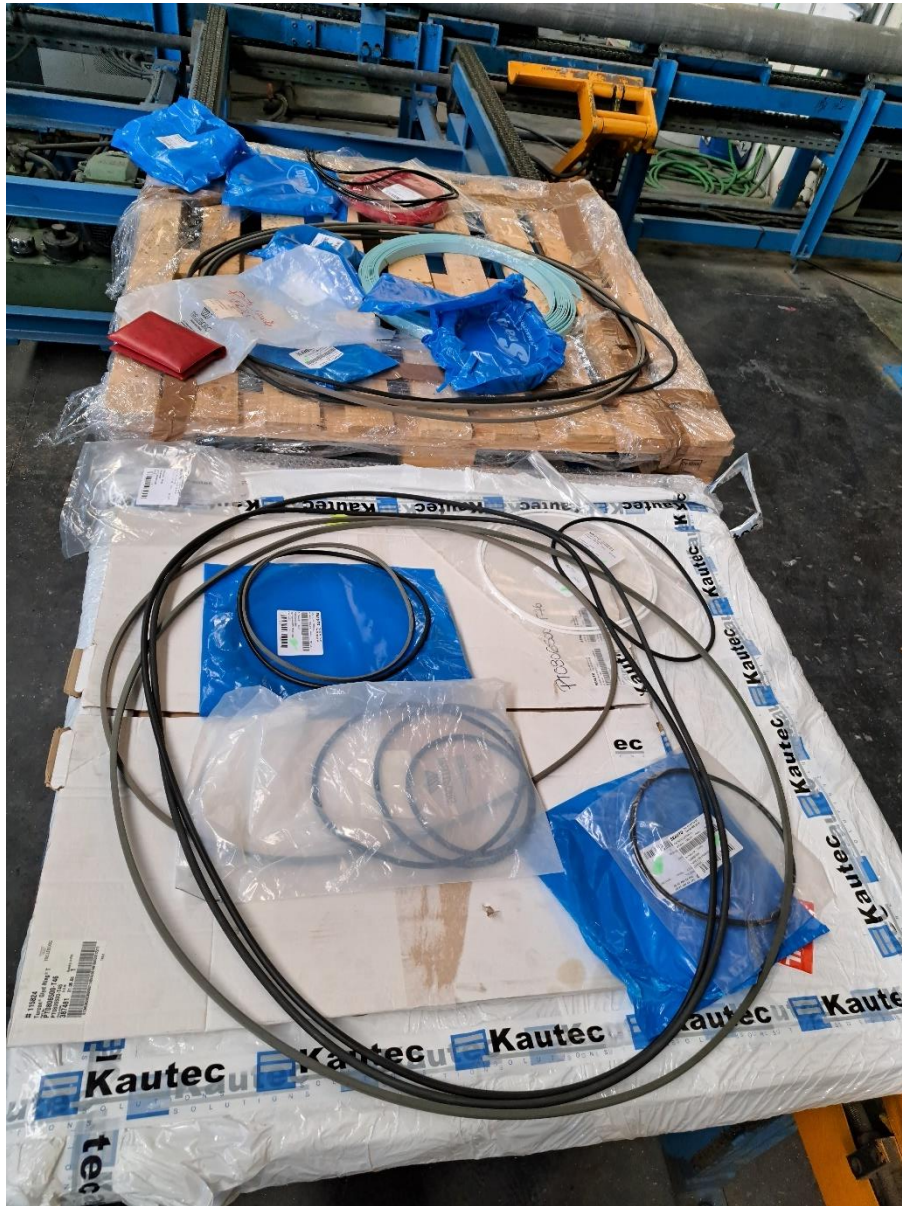
Figura 6.3: Vedantes e cintas para substituição
