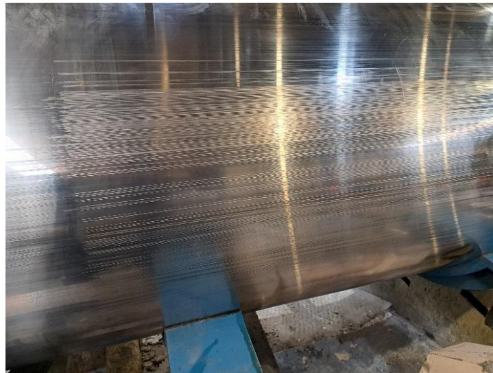
Figura 6.7: Fissuras no cilindro
