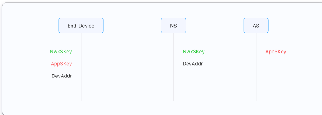
Figura 21 - Processo de autenticação ABP numa rede LoRaWAN (Extraída de [56]).
