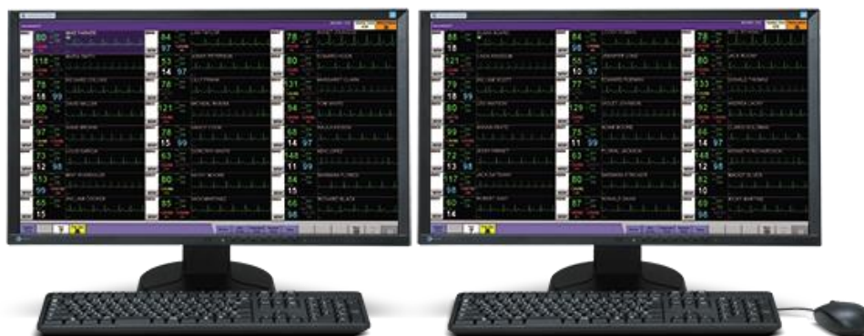
Figura 3.29 – Central de monitorização CNS 9101, marca Nihon Kohden
