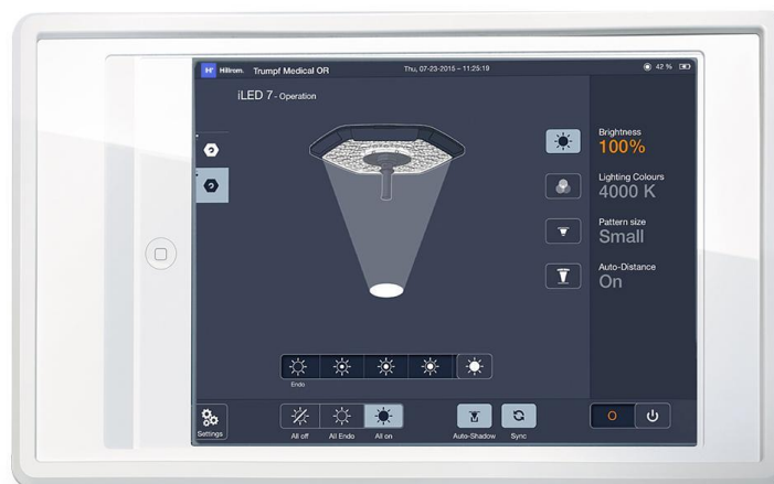
Figura 3.13 – Tablet para controlo remoto das luminárias do iLED 7
