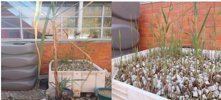
Figura 6: Sistema ZHC E, em estrutura de PVC com macrófitas Phragmites australis .
