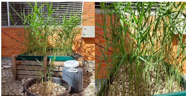
Figura 4: Sistema ZHC P, com estrutura modular em madeira, plantado com macrófitas Phragmites australis .
