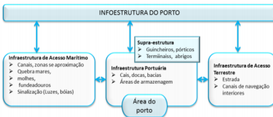
Figura 1 – Esquema da infoestrutura de um porto marítimo.
