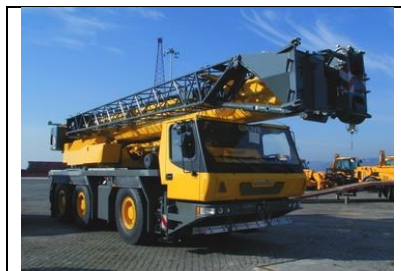
Grove GMK 3050-1 Auto grua com capacidade máxima de 50 Ton.
