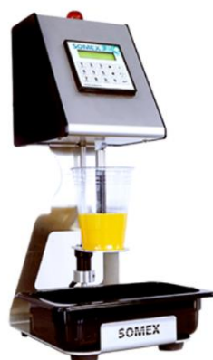
Figura 8: Instrumento de descarbonatação SOMEX.
