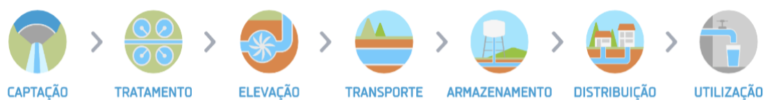
Figura 1.2: Sistema de Abastecimento de Água
