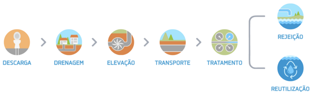
Figura 1.9: Sistema de Drenagem
