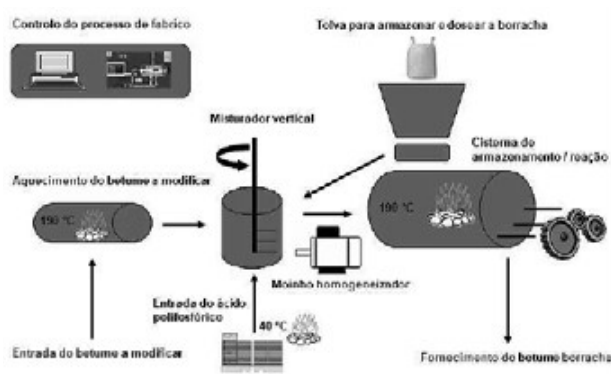
Ilustração 2 Esquema da produção do betume borracha – Elaborado pelo autor
